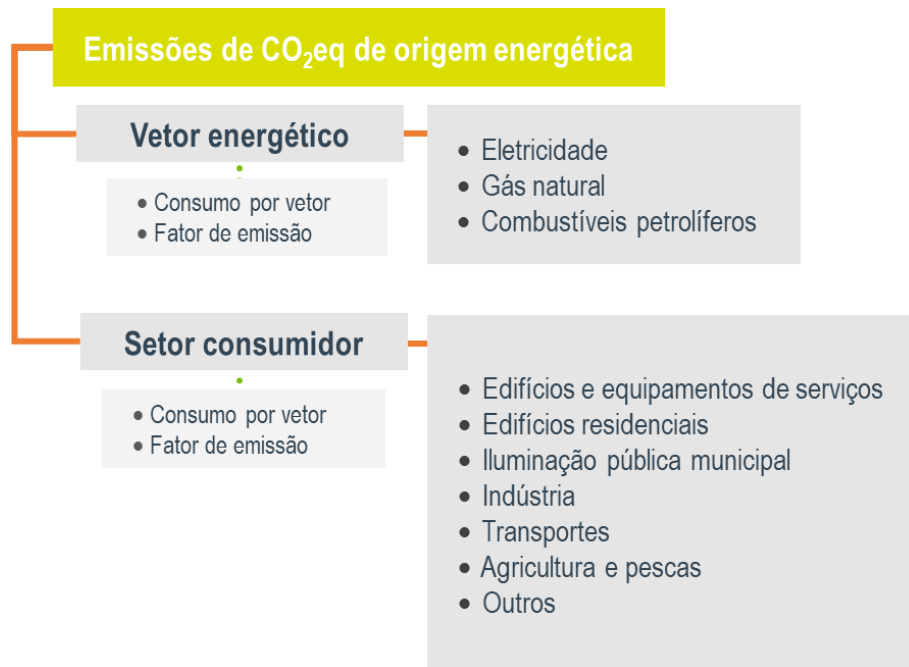
Figura 54 – Representação esquemática da metodologia de cálculo do inventário de emissões de CO 2 eq de origem energética.
